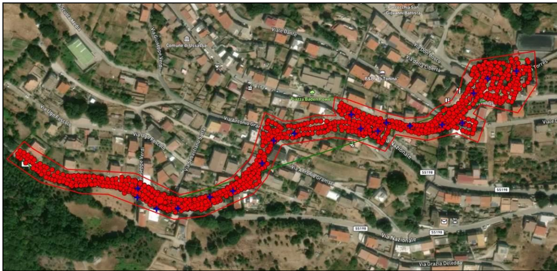
Figura 11 – Schema delle prese fotografiche realmente eseguite (ad ogni punto rosso corrisponde una ripresa)
