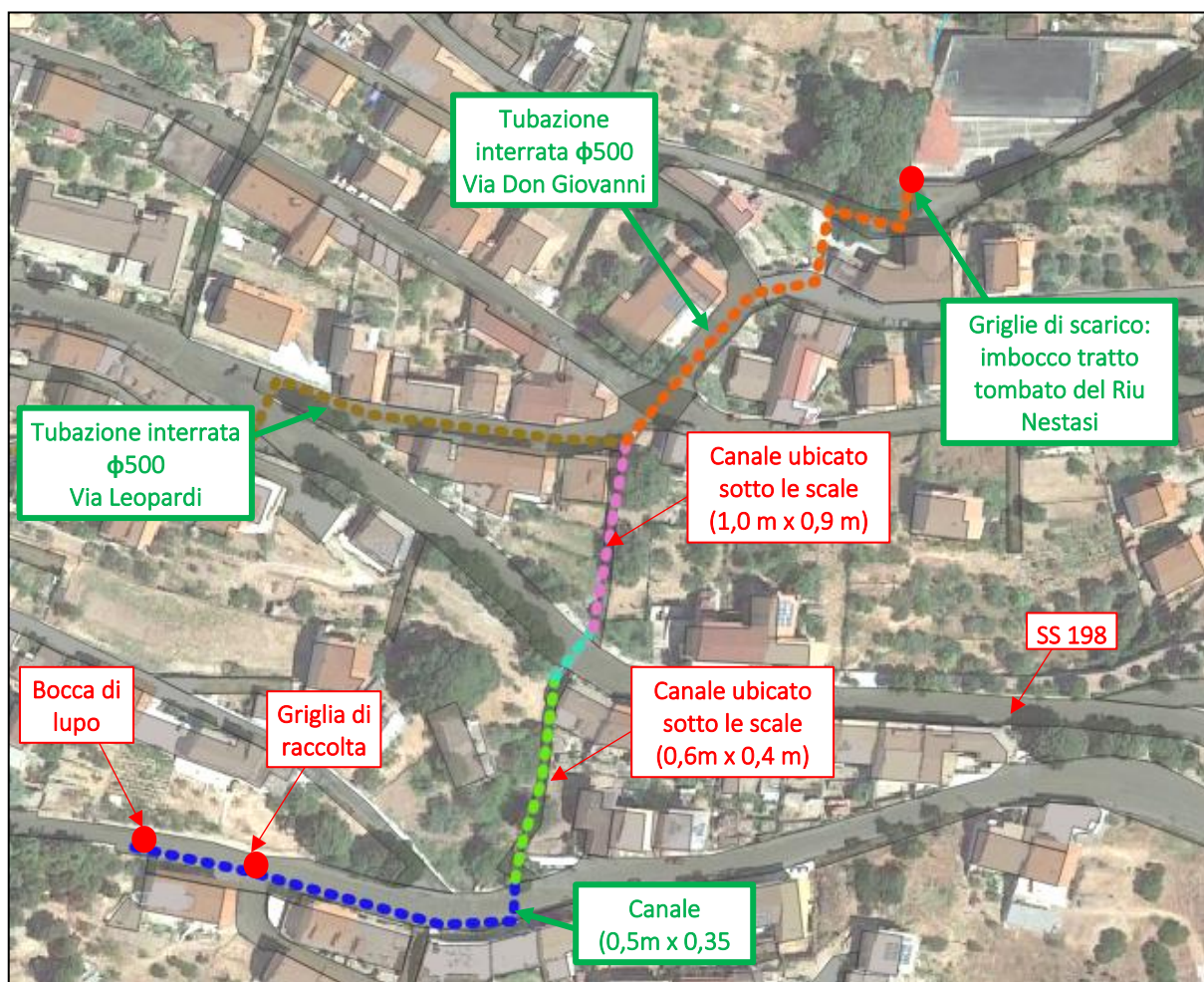
Figura 20 - Sistema di raccolta e smaltimento delle acque verso il Riu Nestasi, allo stato di fatto.
