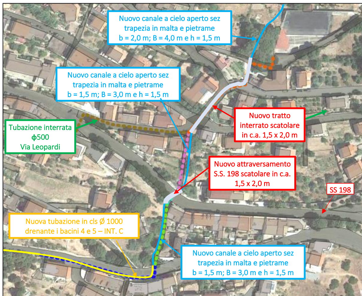
Figura 23 – Sovrapposizione de tracciato del canale esistente (linee colorate tratteggiate) con la traccia planimetrica del nuovo canale relativo al Rio Nestasi.
