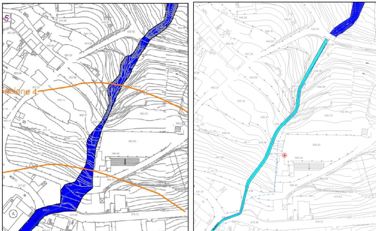
Figura 40 - Area di pericolosità idraulica relativa al Rio Nestasi nel tratto a valle del campo sportivo; a sinistra la perimetrazione vigente (cfr. § 4.1), a destra la nuova perimetrazione nella condizione post intervento.
