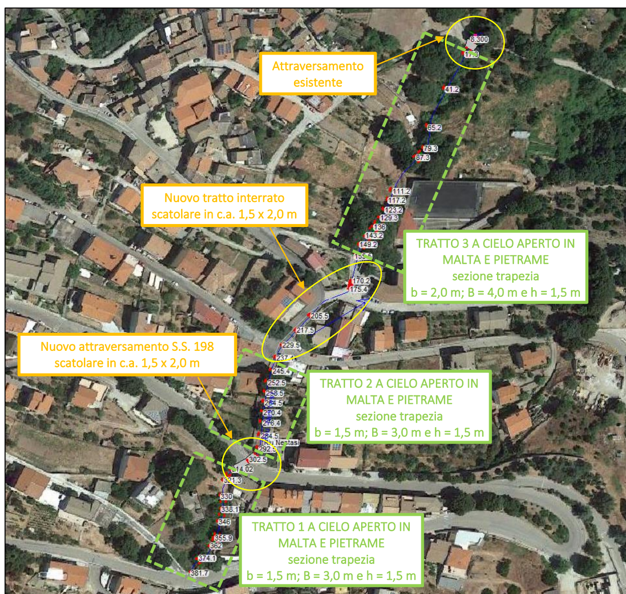
Figura 24 - Estensione planimetrica del modello 1D allestito e rappresentazione delle sezioni di calcolo.
