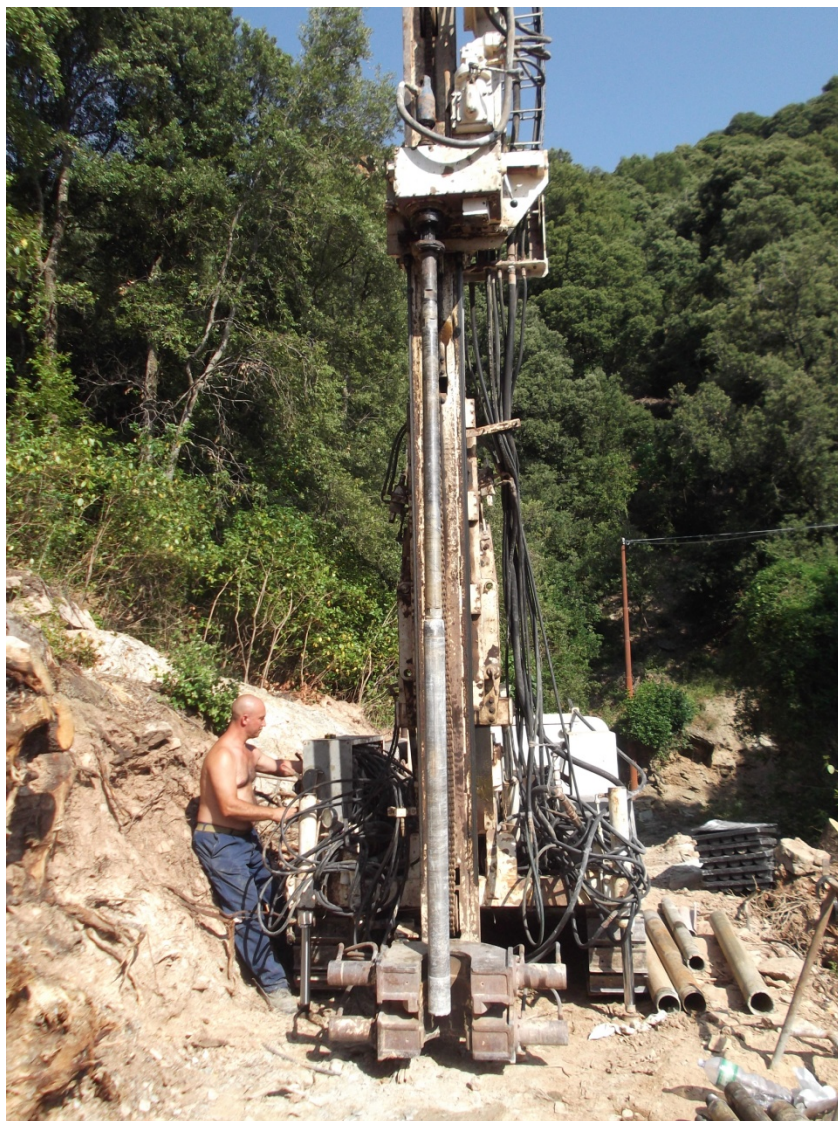
Foto 7 – Trivella in esecuzione sondaggio S1 verticale
